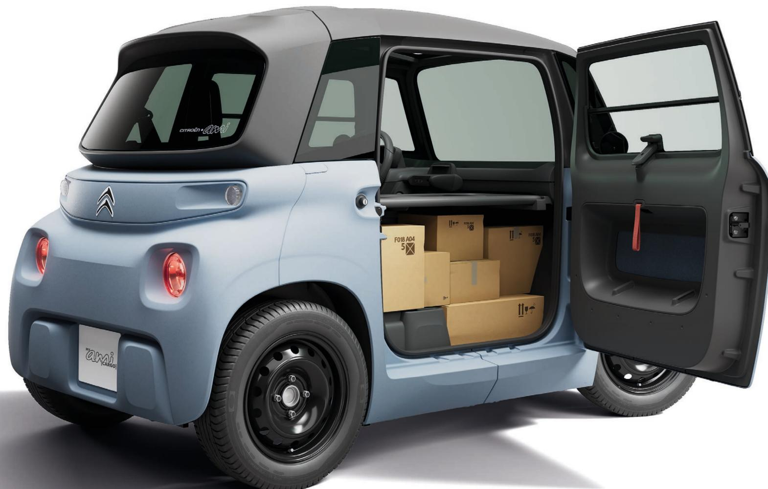
Remplacement du siège passager par une boîte modulaire et protégée. La paroi de séparation verticale vient délimiter la zone conducteur de la zone de chargement.
